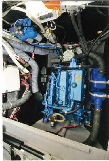
L'installation moteur du Bali a fait l'objet d'une réflexion poussée avec Nanni, on voit ici à l'arrière le rack de fixation de l'alternateur de puissance et de la pompe haute pression du dessalinisateur, qui montre que l'on a pris en compte dès le départ ces approvisionnement stratégiques.
